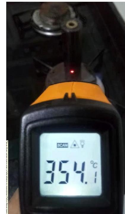
Registro da temperatura do Teste com Termômetro Laser
